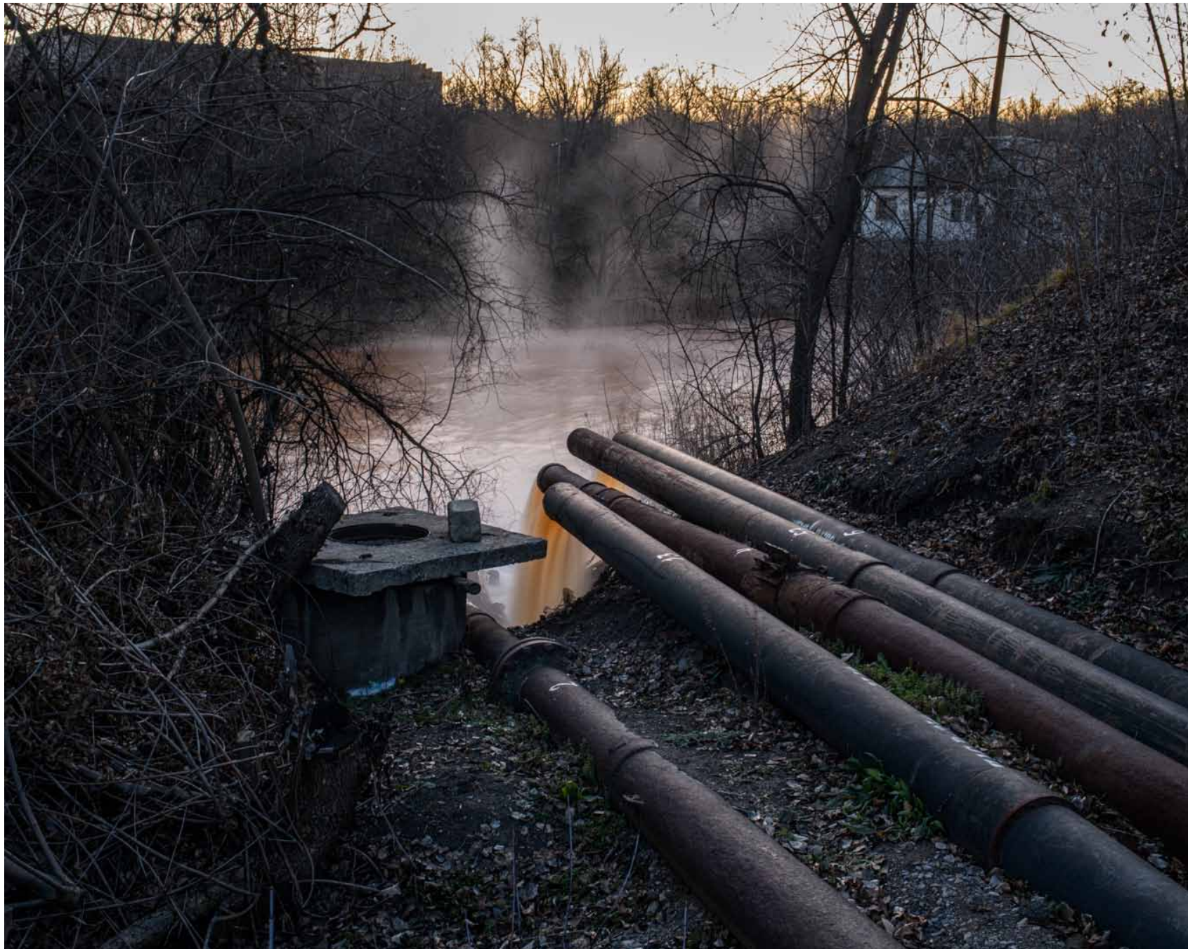
Mine de charbon de Zolote 4 de l'entreprise d'état Pervomaïsk Ougol. Sur les 7 mines appartenant à l'entreprise, 3 sont situées du côté pro-russe. Les 3 mines ne sont plus exploitées, et sont donc inondées. L'eau inonde aussi la mine de Zolote 4 située du côté ukrainien. La mine de Zolote 4 n'a pas la capacité de filtrer l'eau qu'elle doit pomper. Une eau orange est rejetée dans la rivière.
