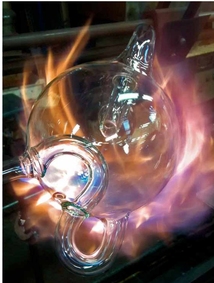
Fabrication par tournage au chalumeau par Stéphane Lefèvre (Meilleur Ouvrier de France)
